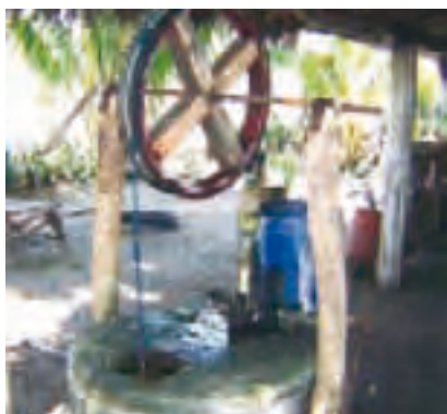
Cuerda y polea: Sistema sencillo de extracción de agua en el que no hay bombeo. Está compuesto por un balde, cuerda, polea y manija, con movimiento circular. Es poco eficiente y laborioso, principalmente si el agua se destina a otros usos que no sean el estrictamente doméstico y unos pocos animales de corral. El contacto del balde, el cual es manoseado, con el agua suele ser una causa de contaminación del pozo. Foto: José Cristóbal E. Betancourt
