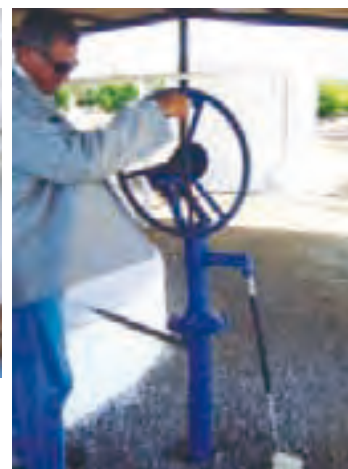
Modelo manual sencillo, pero ligeramente más grande y pesado que los anteriores. Posee manija de movimiento circular, lo que permite cierto movimiento inercial, es decir, el movimiento de bajada del brazo ayuda en parte al movimiento de subida. Si las necesidades de agua son mayores, este modelo sería más adecuado que los presentados anteriormente. Foto: Marcos J. Vieira.
