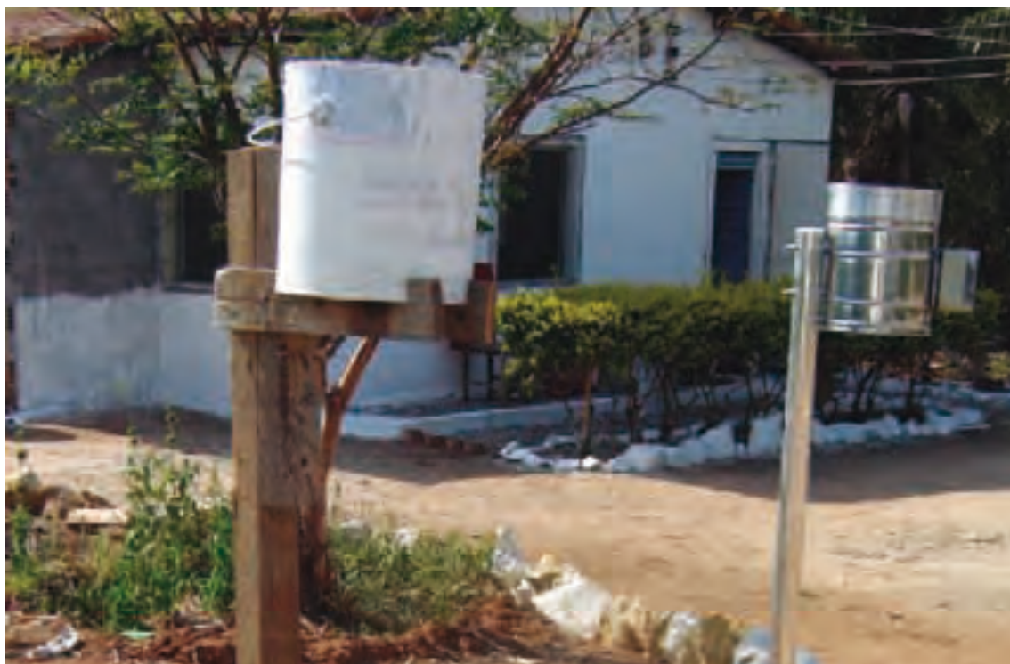
FIGURA 6-I: En primer plano, pluviómetro simple hecho a partir de un recipiente de pintura con los bordes recortados. En segundo plano, equipo "oficial" para comparación.
