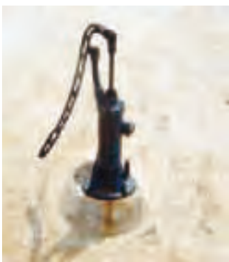
Modelo sencillo de bomba manual. La manija es de movimiento semicircular vertical, lo que no permite movimiento inercial, es decir, cada movimiento hacia abajo (el que produce agua) necesita que el movimiento hacia arriba sea realizado con esfuerzo del brazo, aunque leve. En diferentes países hay variaciones del mismo modelo o más grandes. Se le conoce con el nombre de bomba catracha. Foto: Marcos J. Vieira.
